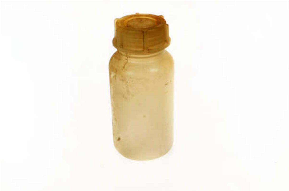
*Weithals Laborflasche mit 65mm Schraubverschluss für 1000ml aus LD-Polyethylen
