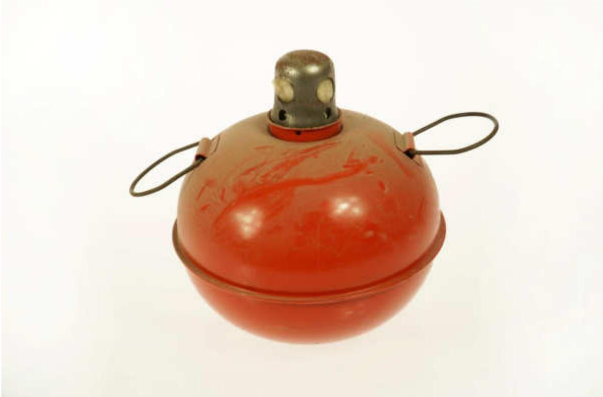
*Baustellen Warnleuchte, Metallgehäuse lackiert, Watte gefüllter Textildocht, Brennerkapsel mit Bajonettverschluss, Abmessungen: 190 Ø x 195 mm, Gewicht: 870 g*
