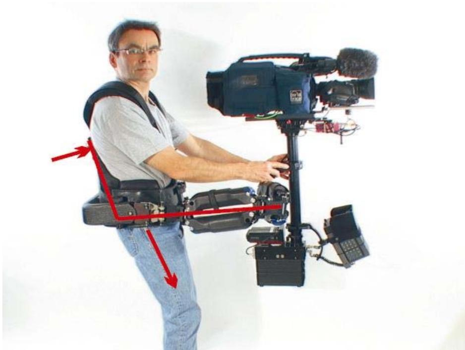
Das Adapterstück am Arm ist seitenverkehrt zur Steadicam Weste. Der Arm geht nach vorne links weg. Der Winkel des Armansatzes kann an der Armaufnahme der Weste über ein Einstellrad eingestellt werden. Die Arbeitsbreite an der Armaufnahme beträgt ca. 45 cm. Als Operator braucht man mehr
